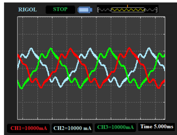
Рисунок 7 – Осциллограммы сетевых токов системы электропривода в режиме рекуперативного торможения
