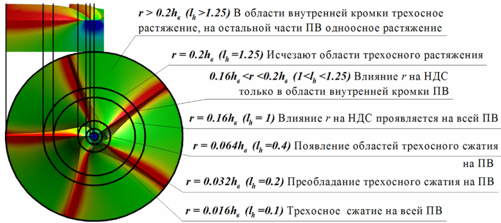
Рисунок 18 – Характерные концентрические области на груди забоя
