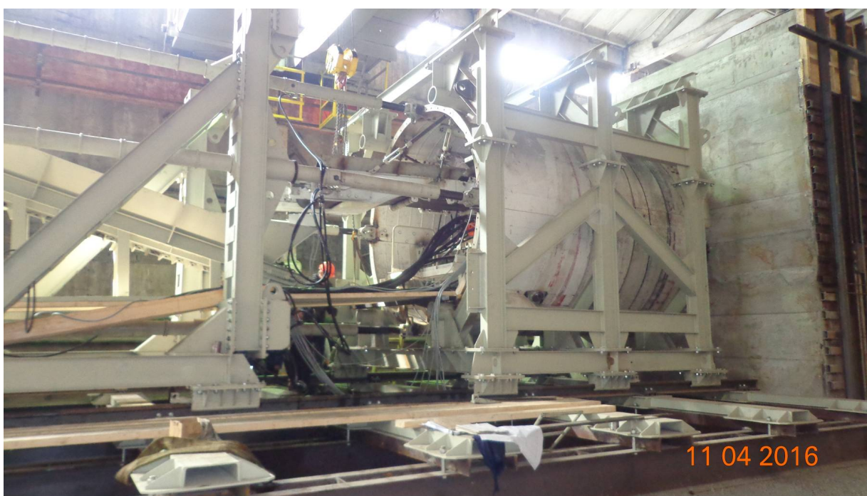
Рисунок 7.12 – Натурные (приемочные) испытания геохода
