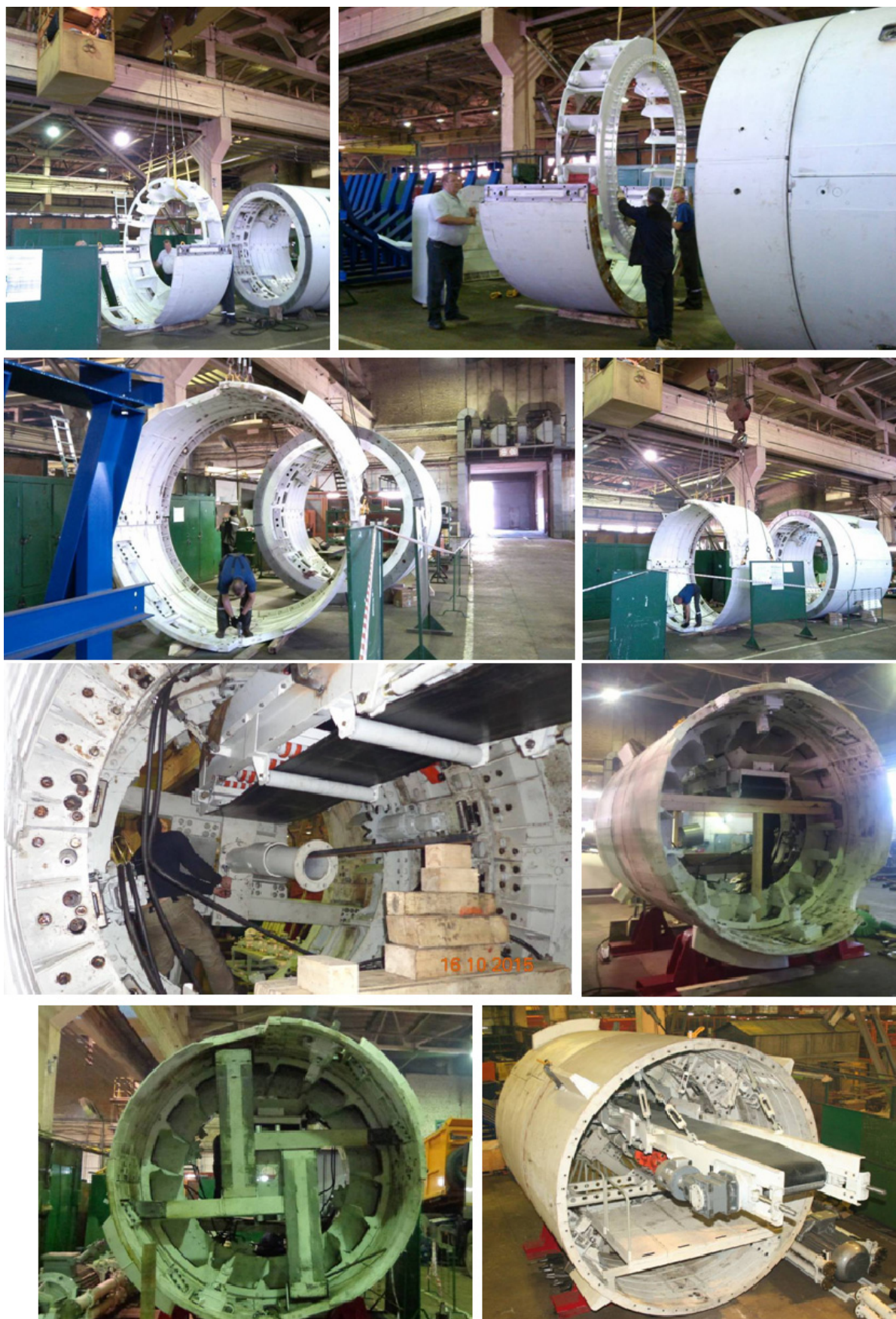
Рисунок 7.8 – Сборка опытного образца геохода
