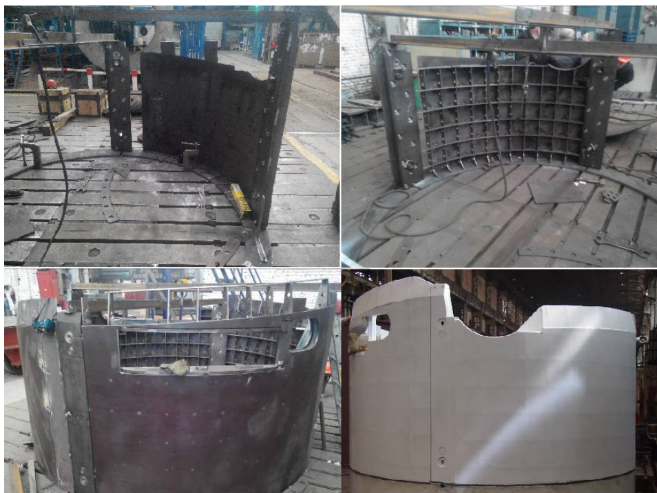
Рисунок 7.6 – Изготовление корпуса головной секции геохода
