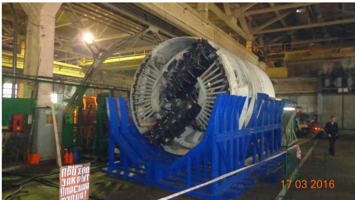
Рисунок 7.11 – Стендовые испытания геохода
