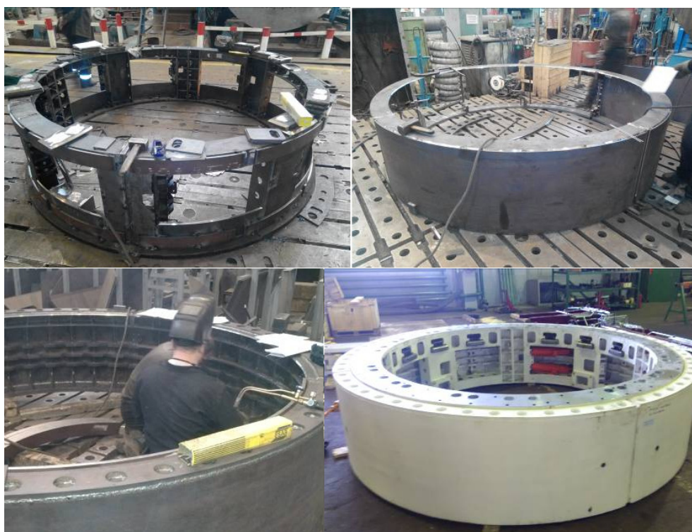
Рисунок 7.7 – Изготовление корпуса модуля сопряжения секций геохода
