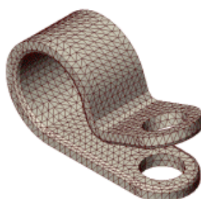
Рисунок 1.25 – Разбиение объемного объекта на конечные элементы
