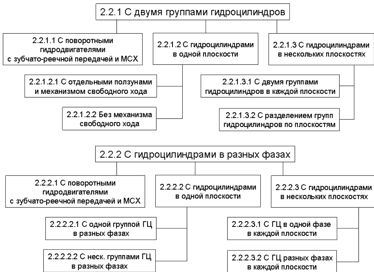
Рисунок 6.14 – Систематизация схемных решений трансмиссии геохода с гидроцилиндрами и непрерывным вращением головной секции
