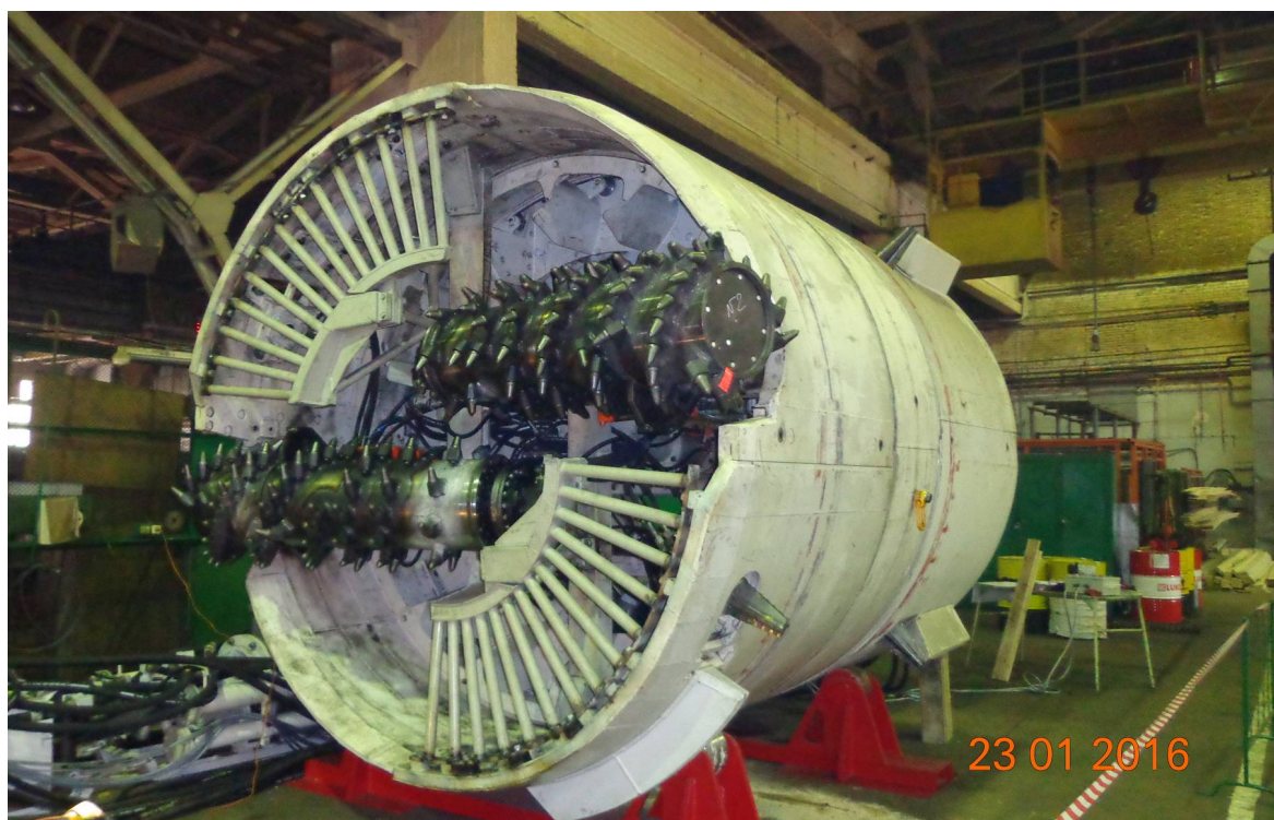
Рисунок 7.10 – Опытный образец геохода. Общий вид
