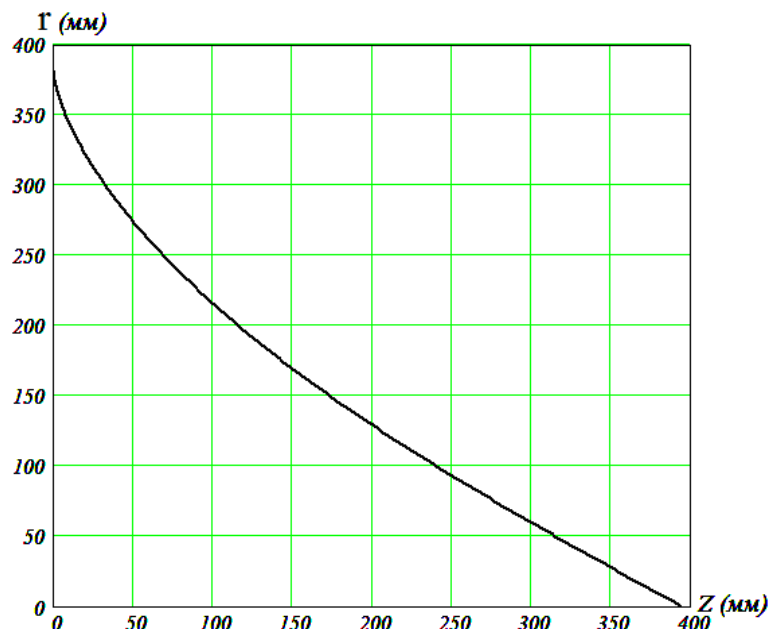
Рисунок 5.46 – Рациональная форма образующей забоя в диапазоне 0 \leq r \leq r_{кр} при критическом значении относительного расстояния l_{кр} = 1.25
