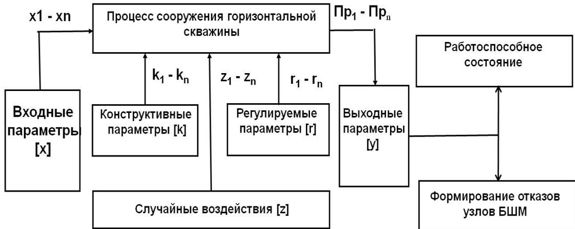
Рис.1. Схема формирования эксплуатационных параметров бурошнековой машины и инструмента
