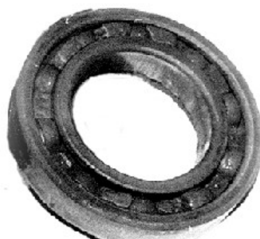
Рис. 4.13. Общий вид подшипника с разрушенными телами качения
