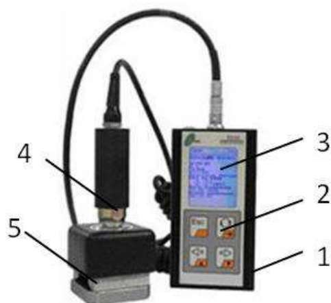
Рис. 2.4 Виброколлектор STD-5101 – корпус; 2 – органы управления; 3 – дисплей; 4 – датчик вибрации; 5 – установочный магнит
