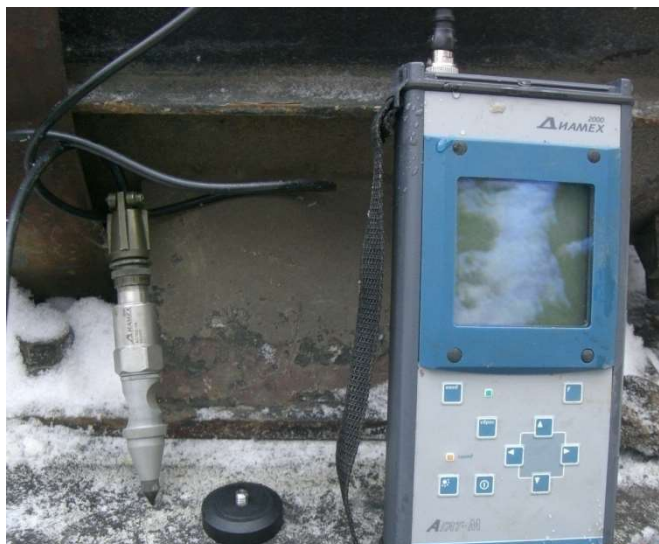
Рис 4.7. Общий вид виброанализатора Агат-М
