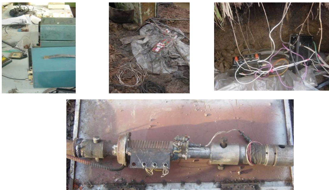
Рис.4.9. Элементы приборного комплекса для регистрации энергомеханических характеристик комплекта бурошнекового оборудования
