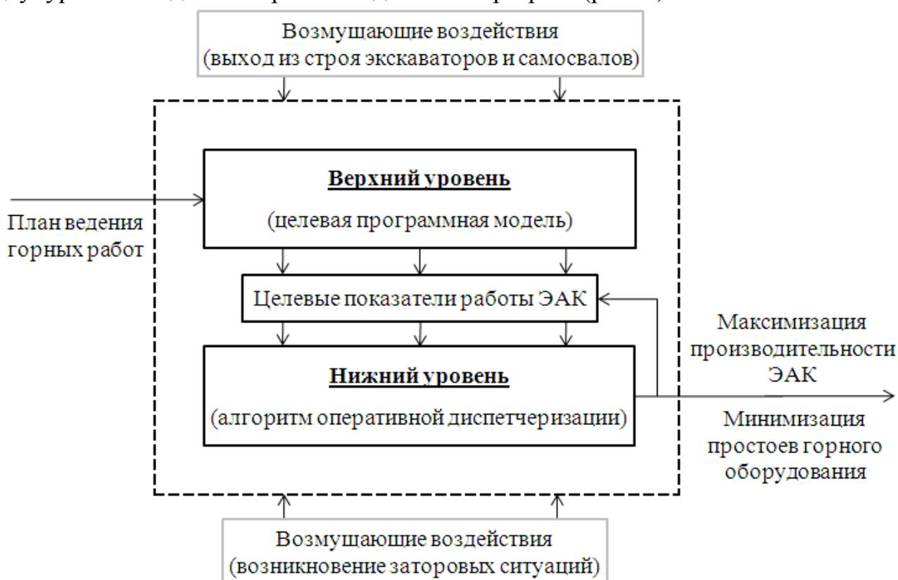
Рисунок 1 – Схема двухуровневой диспетчерской модели ЭАК разреза
