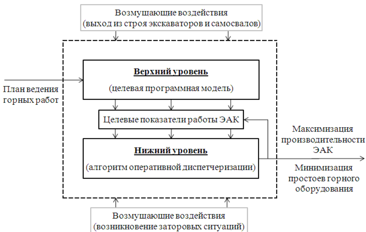
Рисунок 2.1 – Схема двухуровневой диспетчерской модели ЭАК разреза
