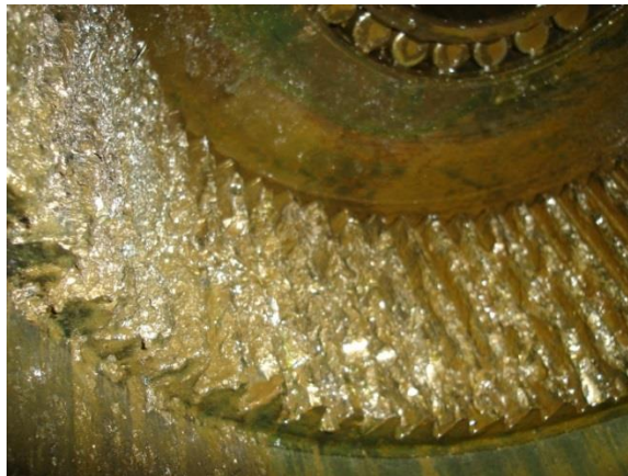
Рис. 10. Дефект зубчатой передачи в волновом редукторе резания комбайна СМ-130К
