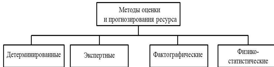
Рис. 4. Классификация методов прогнозирования остаточного ресурса оборудования
