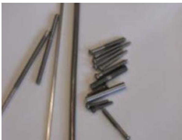
Рис. 1.2. Облегченные конструкции крепежных изделий из наноструктурного титанового сплава.
