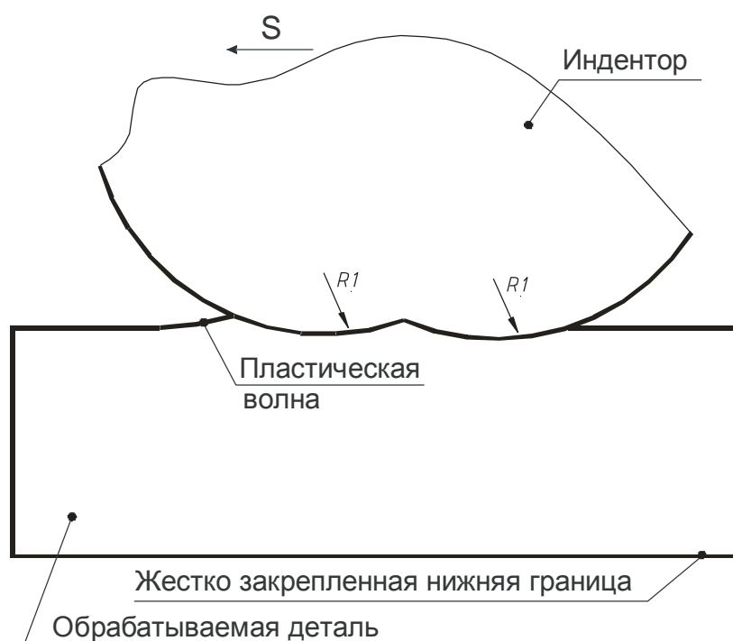
Рис. 4.32. Постановка конечно-элементного моделирования обработки роликом специального профиля
