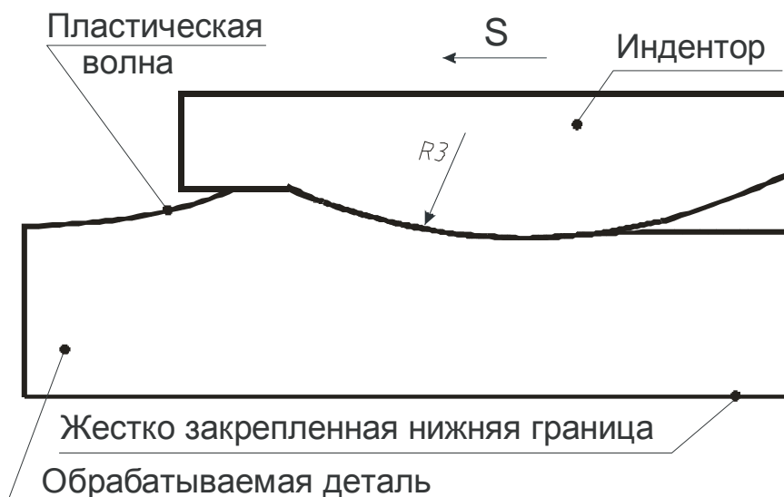
Рис. 1.2. Постановка конечно-элементного моделирования обработки роликом специального профиля 2-ого типа
