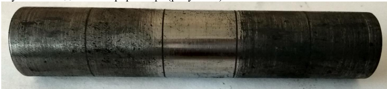
Рисунок 2 – Поверхность с нанесенным смазочным слоем: 1, 2 пояс - Ra 0.75 мкм, 3 пояс - Ra 0.12 мкм, 4, 5 пояс - Ra 1.32 мкм
