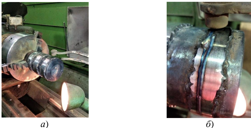
Рисунок 1 – проведение электродугового термического упрочнения, а – установка образца в патрон станка, б – поверхность образца после испытания
