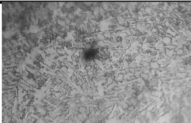
Рисунок 2 - Структура исследованного чугуна СЧ20 в зоне оплавления, x990
