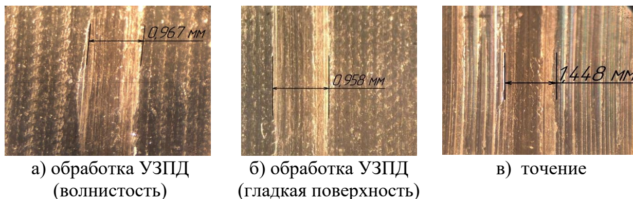
Рисунок 3. Канавки – следы воздействия деформатора на поверхностях, обработанных различными способами.
