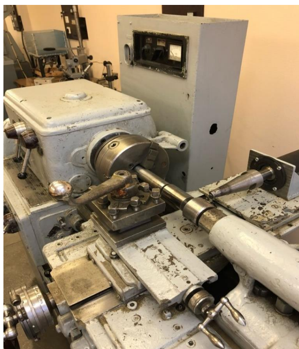
Рисунок 1 – Установка для проведения испытания на износостойкость
