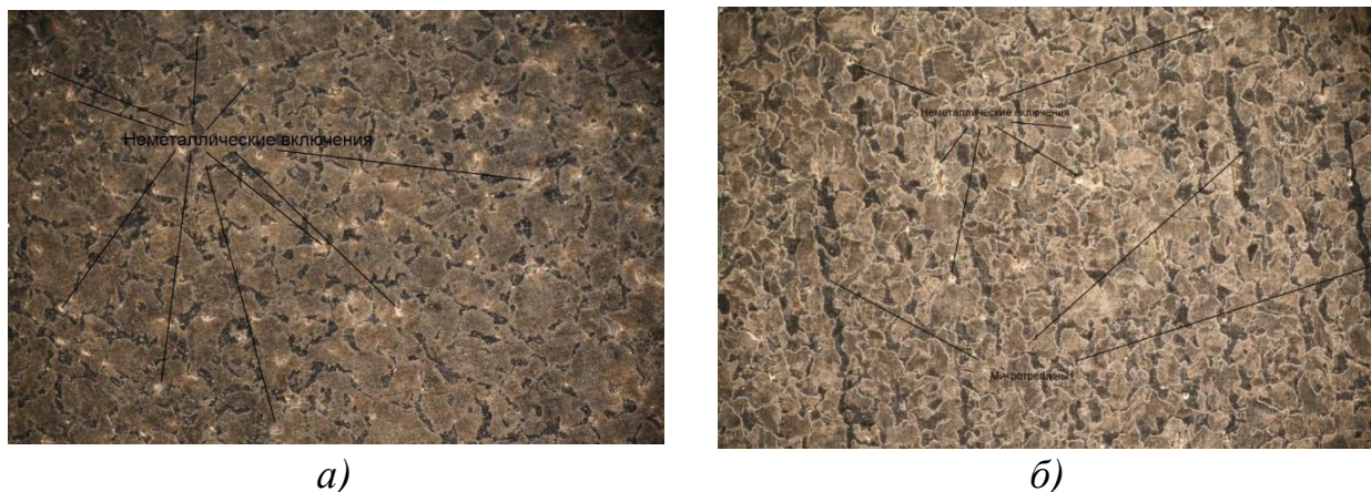
Рис. 4. Структура металла образцов фрагментов цилиндров, \times 200 : а – разрушенного по проушине; б – разрушенного по штоку
