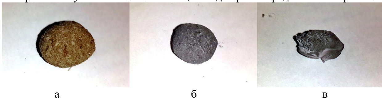
Рис. 2: Образцы до и после осуществления процесса термической переработки: а – исходные гранулы, б – гранулы после термического упрочнения, в – образец пироуглерода, образующийся в реакторе в ходе процесса.
