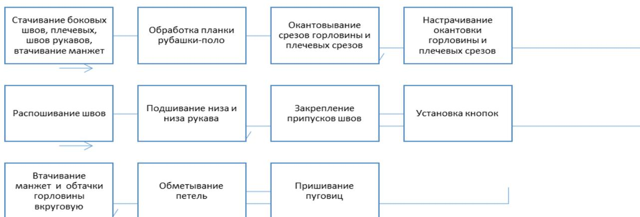
Рисунок 1 – Производственный процесс изготавливаемые футболки
