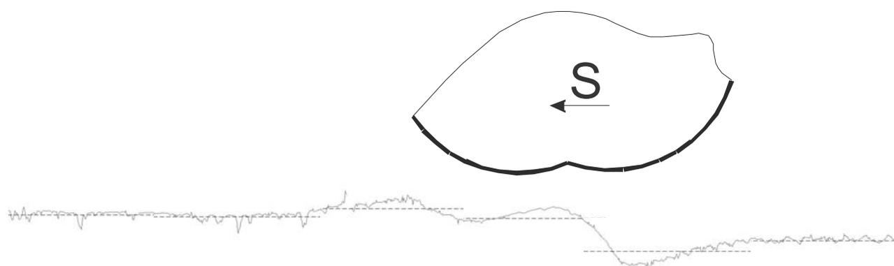
Рисунок 8 - Пример профилограммы очага деформации (образец 1.3)
