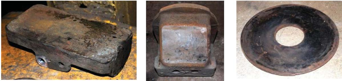
Рисунок 2 - Износ колпака скользуна, фрикционного клина, диска подпятника
