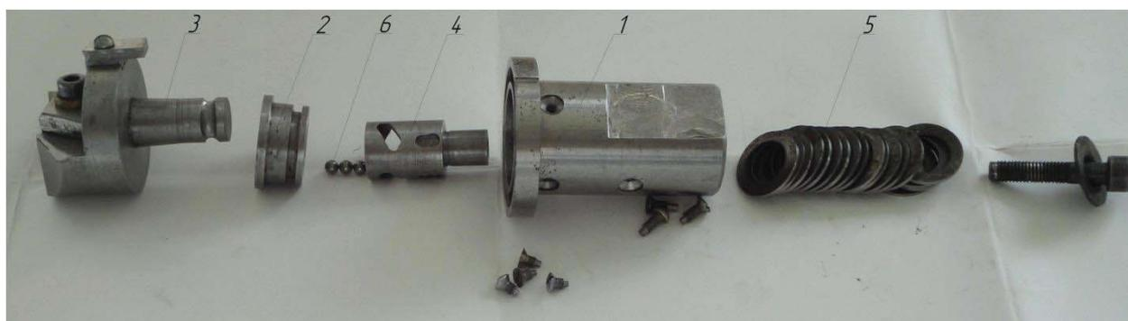
Рисунок 1 - Элементы конструкция модульной инструментальной оснастки
