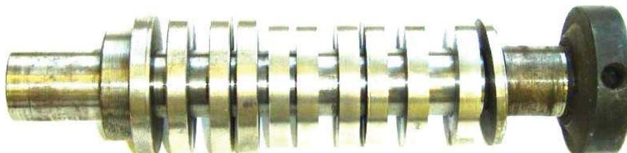
Рисунок 3 - Оправка специальная цилиндрическая с образцами-кольцами
