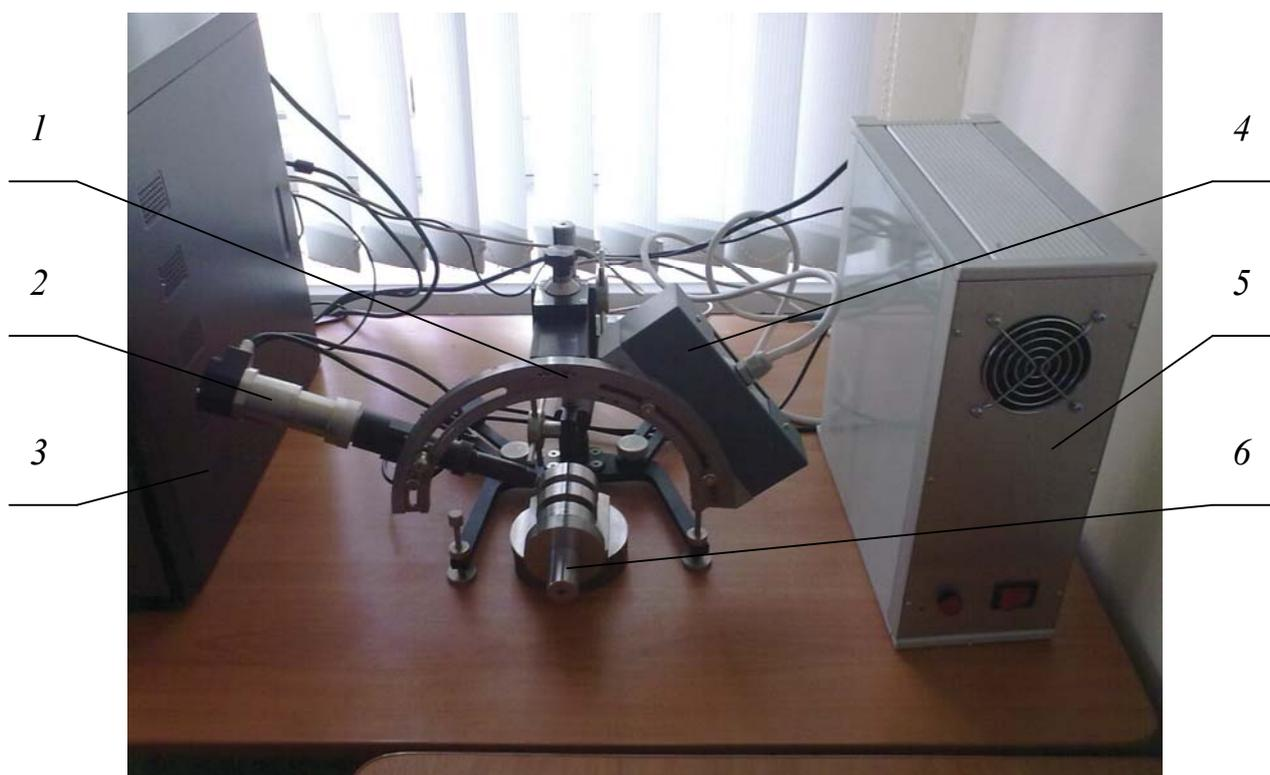
Рисунок 2 - Внешний вид рентгеновского измерительного комплекса «Рикор-7»: 1 – гониометрический узел; 2 – рентгеновская трубка; 3 – персональный компьютер; 4 – детектор; 5 – вычислительный блок; 6 – заготовка
