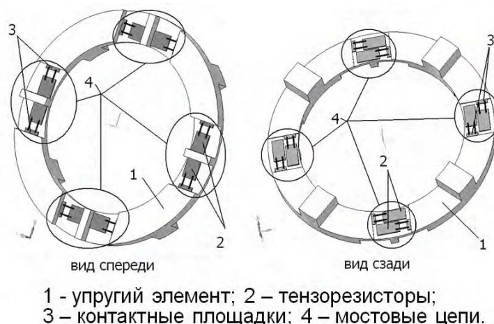
Рис. 4. Расположение тензорезисторов на измерительном модуле
