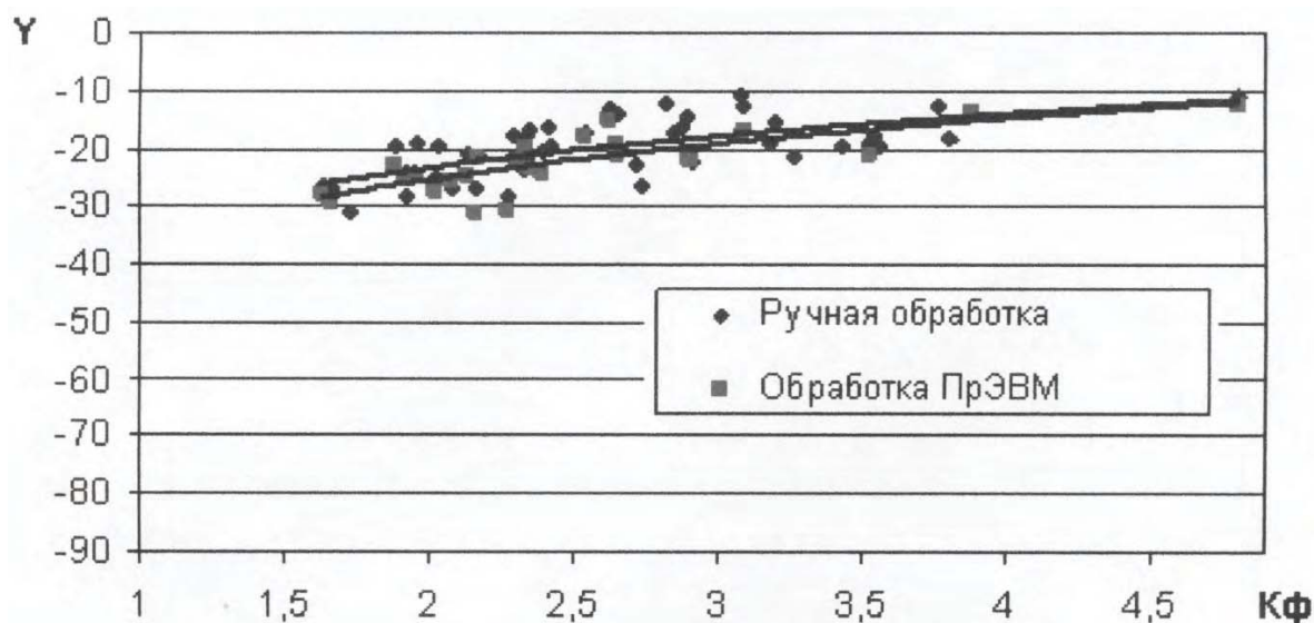
Рис.2. Зависимости передних углов у радиально ориентированных шлифовальных зёрен от коэффициента формы K_\phi , при гипотетическом износе до 1/2L , полученные вручную и с помощью ПрЭВМ
