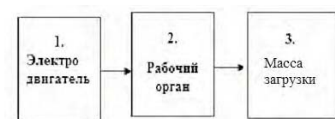
Рис. 2. Схема передачи движения от электродвигателя к частицам масс загрузки в предлагаемых конструкциях бетоносмесителей на базе винтовых барабанов
