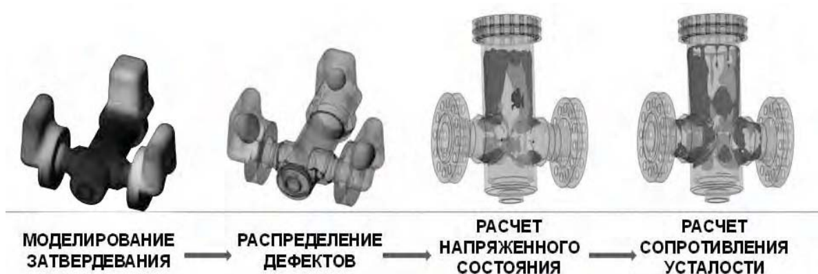
Рис.1. Методика разработки литейной технологии, учитывающая внесенные технологические дефекты
