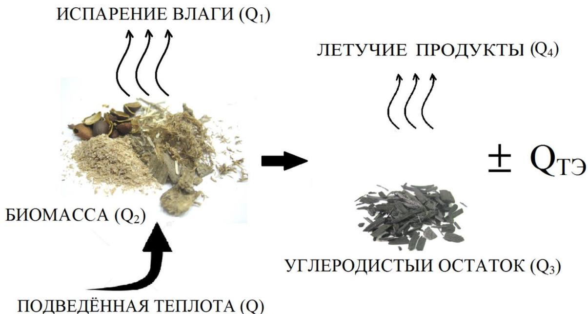
Рис. 2 – Схема распределения теплоты в процессе пиролиза биомассы
