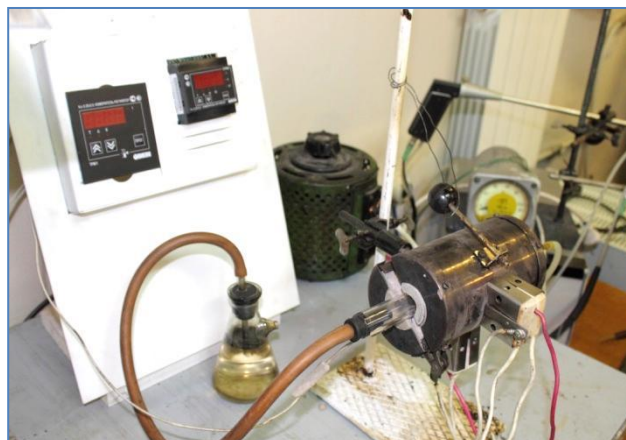
Рис. 1. Внешний вид лабораторной установки по термической переработке топливных гранул
