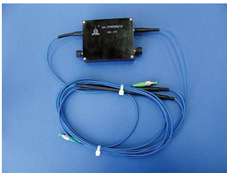
Рисунок 3 - Волоконно-оптический датчик угла наклона ASTRO A541 и его характеристики
