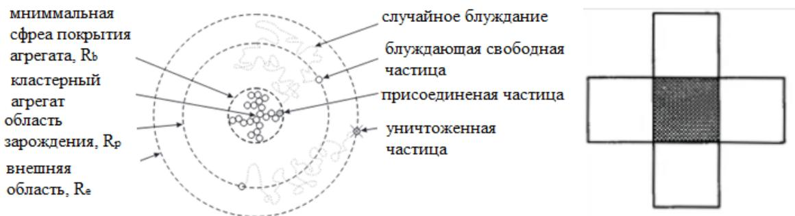
Рис.3. Схема DLA для двумерного случая    Рис.4. Окрестность фон Неймана
