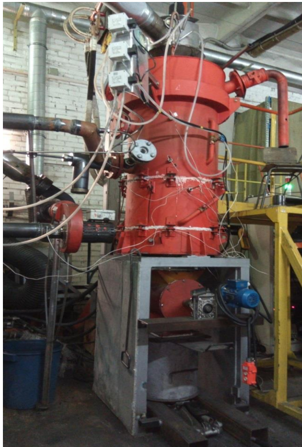
Рисунок 1. Внешний вид электропечи шахтной пиролизной (промплощадка ООО «ЭПОС-Инжиниринг»)
