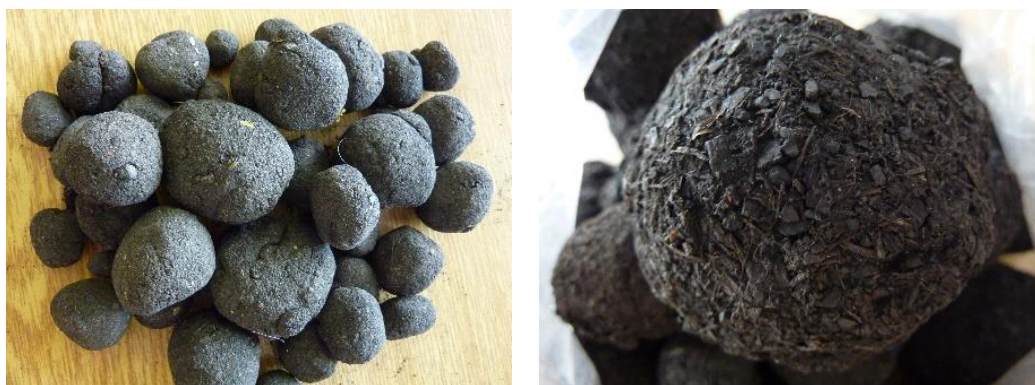
Рис. 4 Топливные гранулы при содержании связующего 30-35% мас.
