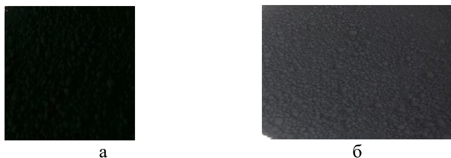
Рис. 2. Общий вид наполнителей: а – УТО; б – технический углерод марки N 330
