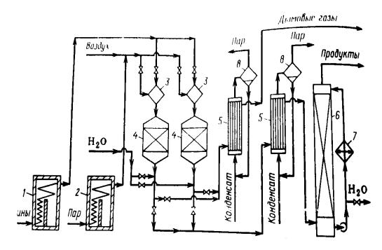
На схеме изображено: 1,2 –трубчатые печи; 3 – смесители; 4 – реакторы кипящего слоя; 5 котлы – утилизаторы; 6 –скруббер; 7 – холодильник; 8 – паросборники; 9 – насос.
