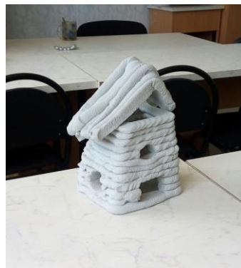
Рис. 4. Результат печати и удаления из схватившегося образца оконных вставок. Готовый домик
