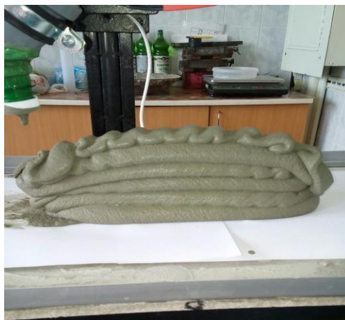
Рис. 2. Результат печати с формующей насадкой с отверстием в 7 мм
