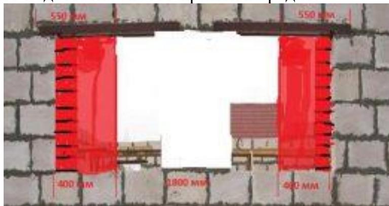
Рис.3. Конструкция окна при уменьшении его проема.
