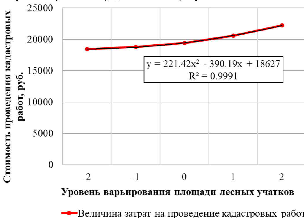
Рисунок 2 – График зависимости затрат на проведение кадастровых работ от уровня варьирования площади лесного участка
