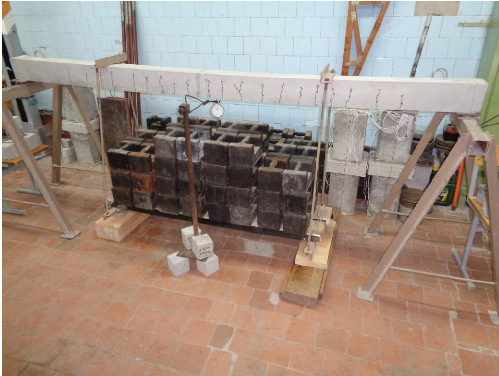
Рис.2. Конструкция под контрольной нагрузкой по проверке жесткости и трещиностойкости (5-й этап). Нагрузка P_{\text{доп}} = 439 кгс.
