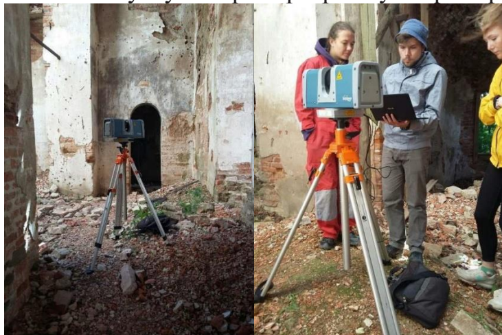
Рисунок 2 – Лазерный сканер Surphaser 25HSX IR_X в рабочем положении
