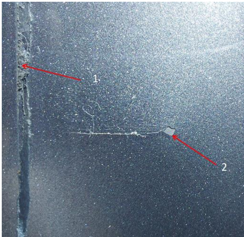
Рисунок 3 – Повреждение лакокрасочного покрытия 1 – наслоение лакокрасочного покрытия 2 – сколы лакокрасочного покрытия
