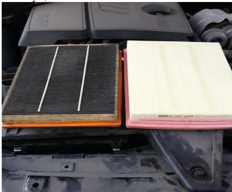
Рисунок 1 - Использованный и новый воздушный фильтр ДВС
