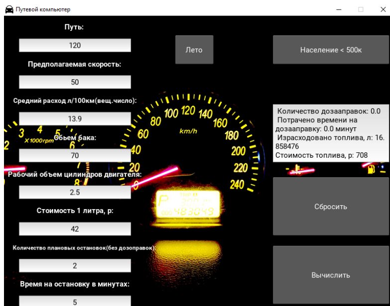
Рисунок 2 – Интерфейс программы «Путевой компьютер» при расчете топлива на основе исходных данных
