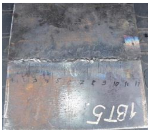
Рис. 1 КСС №1 с дефектами для разрушающего и теплового контроля
