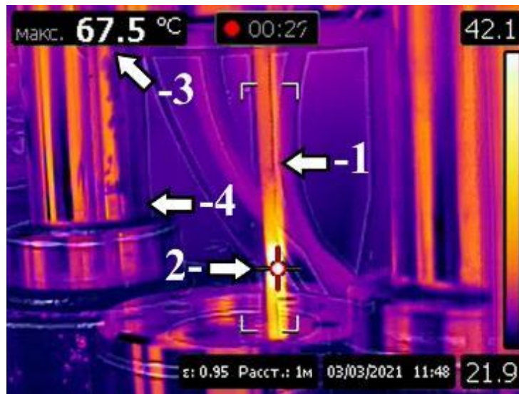
Рис. 5 испытание образца из стали 09Г2С, толщиной 6,0 мм (1 – испытываемый образец, 2 – точка максимального нагрева, 3 – максимальная температура нагрева образца, 4 – разрывная машина РМ-50М)
