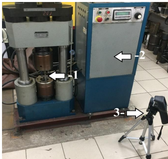
Рис. 3 Процесс эксперимента (1 – исследуемый образец, 2 – разрывная машина РМ-50М, 3 – тепловизор Flir E60)
