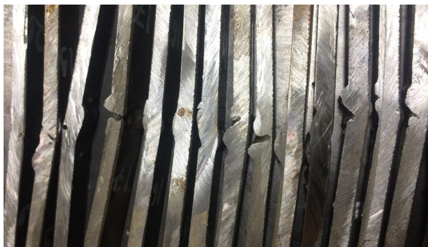
Рис. 2 Образцы из стали 09Г2С, толщиной 6,0 мм
