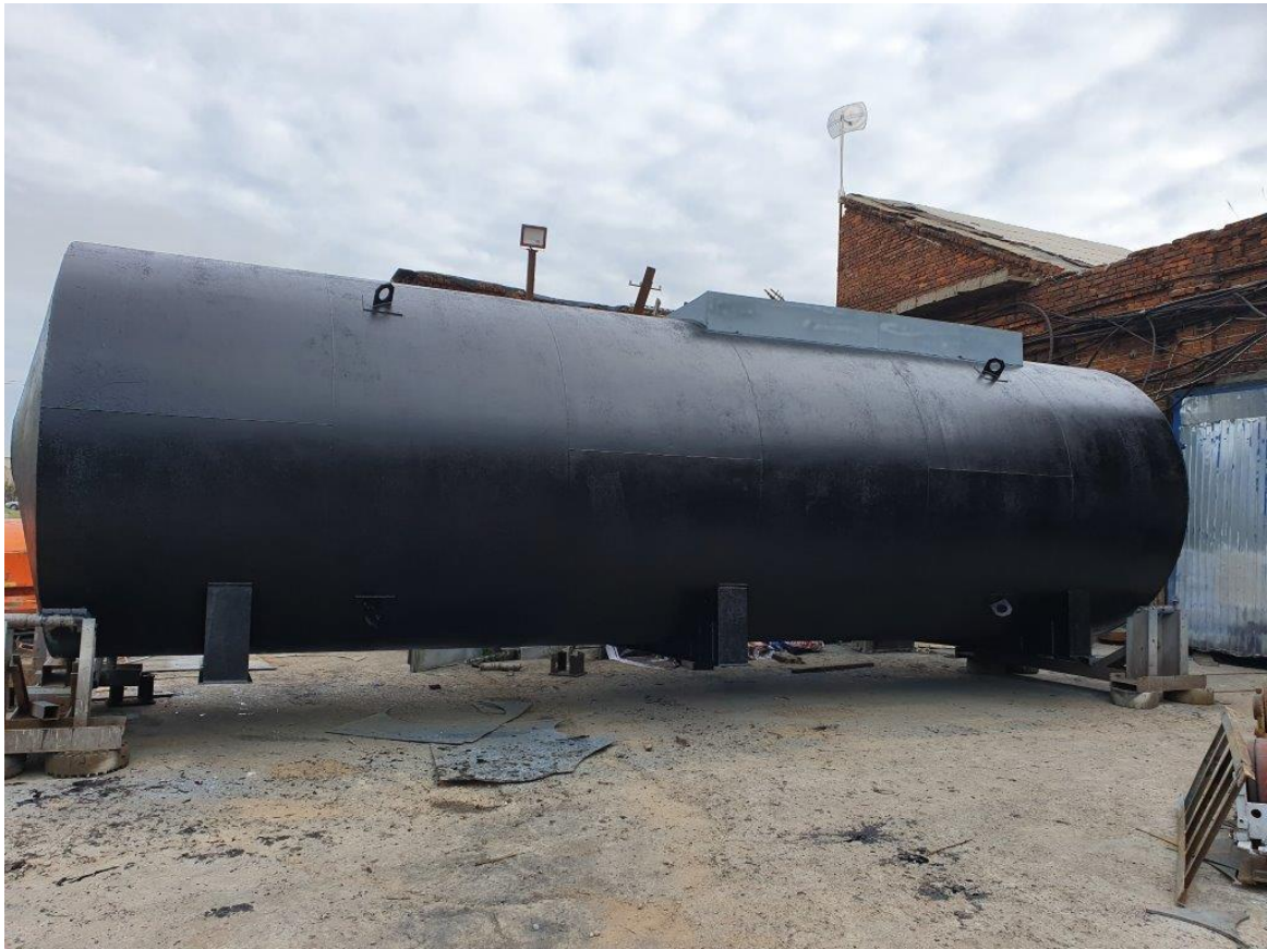
Рисунок 1 – Резервуар горизонтальный стальной подземный двустенный (РГСД), хранения нефтепродуктов
