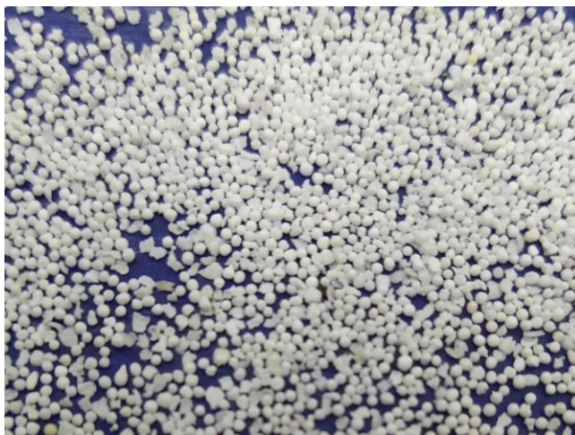
Рис. 1. Внешний вид полого сферокорунда марки ЭС 63Н.
