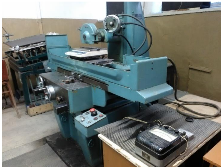
Рис. 2. Плоскошлифовальный станок модели 3Г71 с двухкомпонентным динамометром, использованный для сравнительных испытаний.
