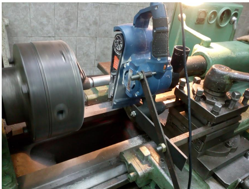
Рис. 1. Внешний вид съёмного модуля для ленточного шлифования на токарно-винторезном станке 1К62.
