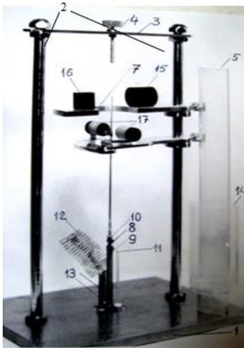
Рисунок 2 – Оптико-механическая часть установки со снятой вакуумной трубой
