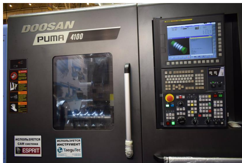
Рис. 1 — Токарный станок Doosan Puma 4100 с САМ-системой ESPRIT На практике обычная последовательность действий при изготовлении какой-либо детали на станке с ЧПУ, такова:
