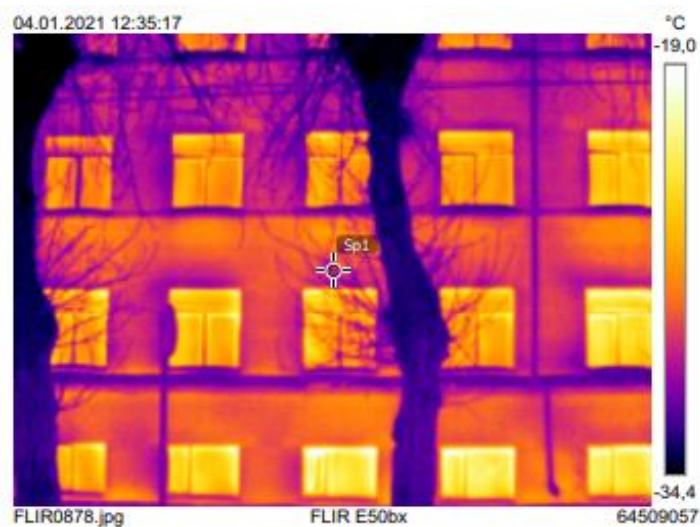
Рис. 3. Термограмма фрагмента средней части здания
