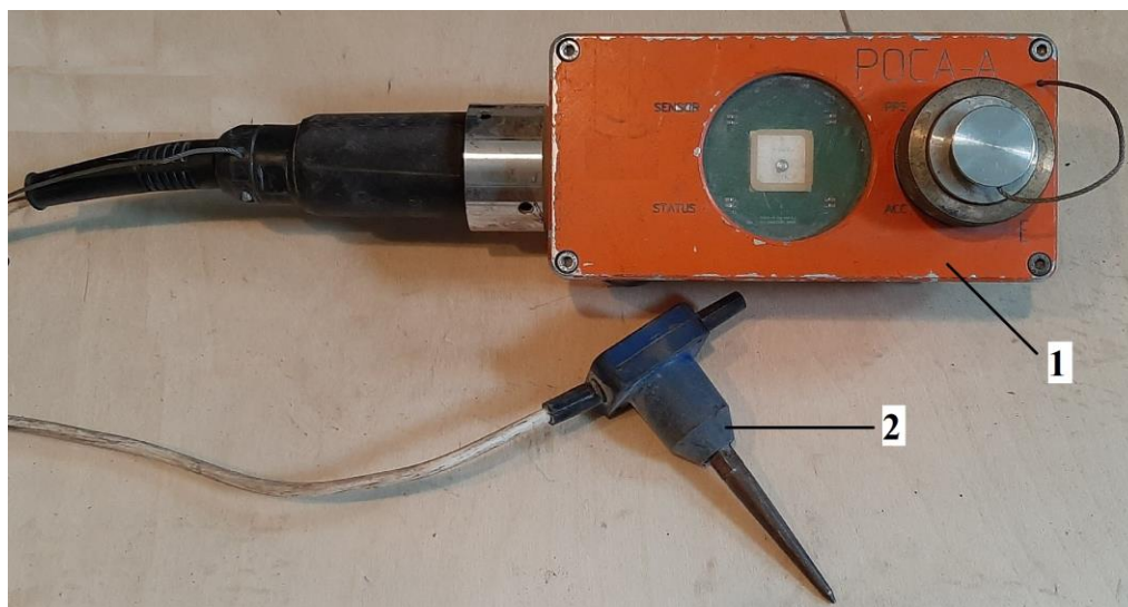
Рисунок 2 – Комплект сейсмической аппаратуры: 1) – автономная сейсмическая станция «РОСА-А»; 2) геофон GS-20DX.
