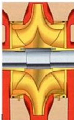
Рис. 2. Рабочее колесо с двусторонним всасыванием
