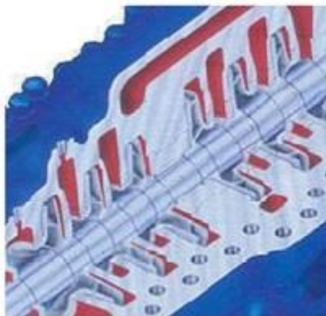
Рис. 3. Насос с противоположно направленными рабочими колесами
