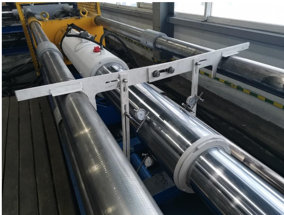
Рис. 4 – Измерение перемещений рабочего цилиндра гидростойки двойной гидравлической раздвижности на стенде
