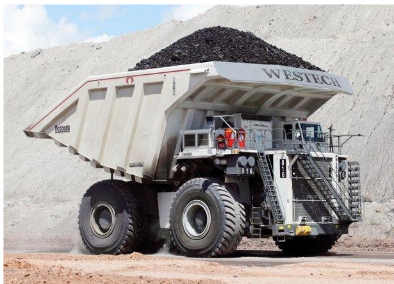
Рисунок 2. Угольный кузов Westech, грузоподъемностью 447 тонн.
