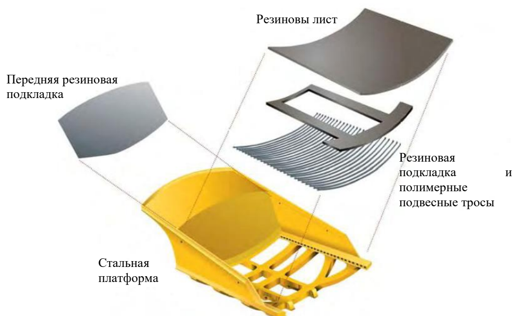
Рисунок 8. Схема грузовой платформы Duratray с подвесным дном.
