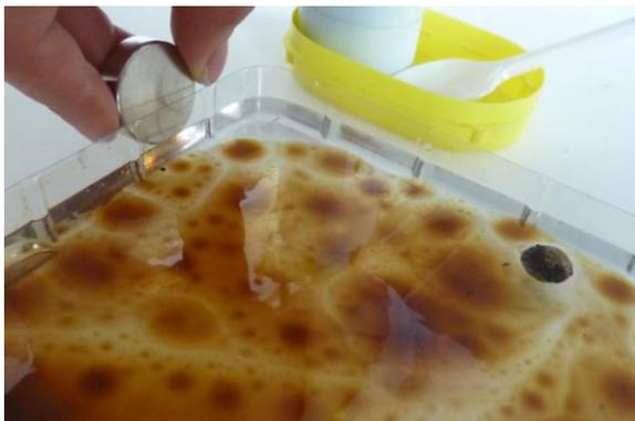
Рис.4. Лабораторные испытания исходных гранул с разливом нефти
