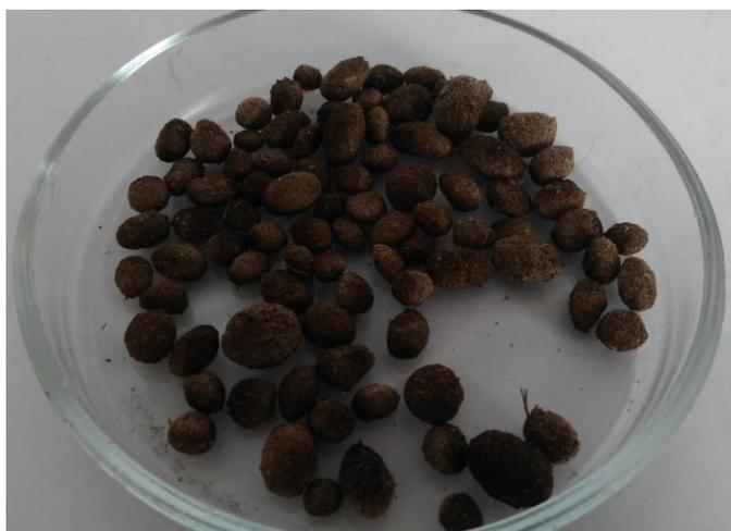
Рис. 3. Гранулы на выходе из барабанного гранулятора
