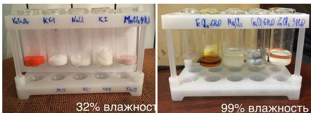
Рис. 2. Примеры измерения влажности физико-химическим гигрометром
