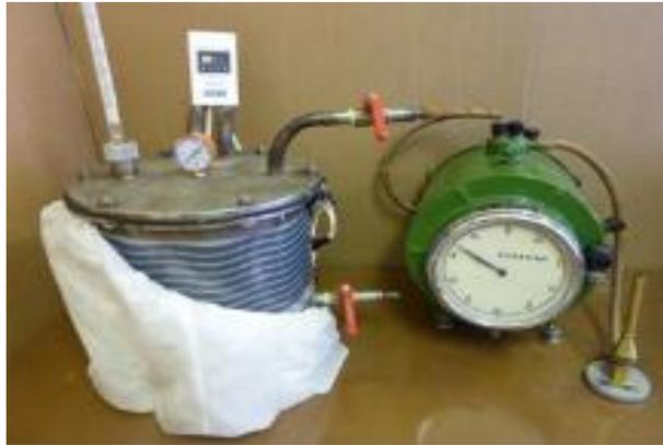
Рис. 1. Установка для анаэробного сбраживания животноводческих отходов
