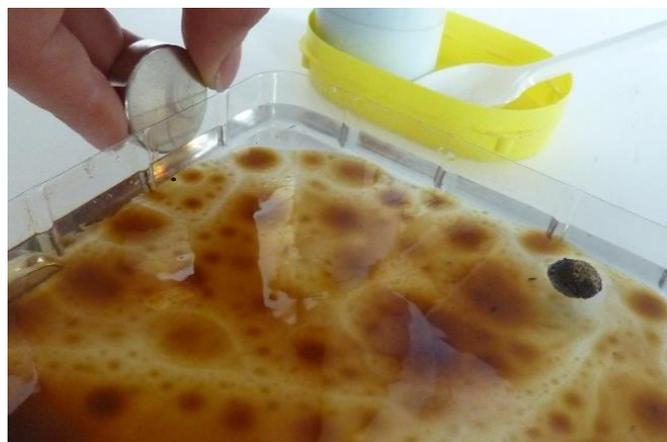
Рис. 4. Лабораторные испытания сорбции нефти магнитными гранулами
