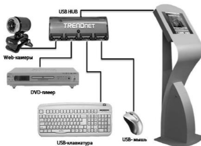
Рисунок 1. Подключение устройств USB.
